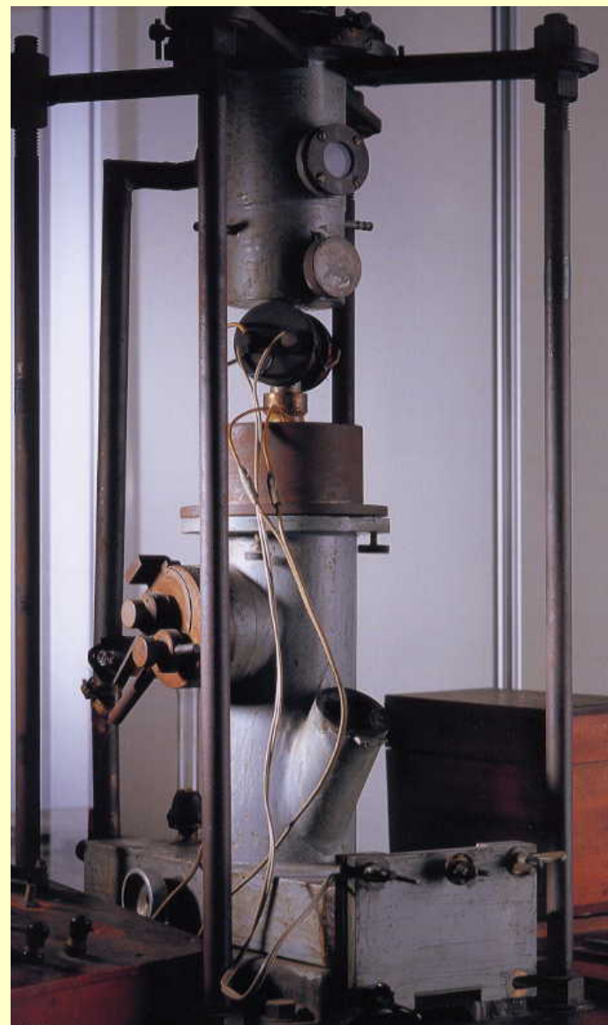
上田良二が設計した電子回折装置（名古屋大学博物館蔵）
